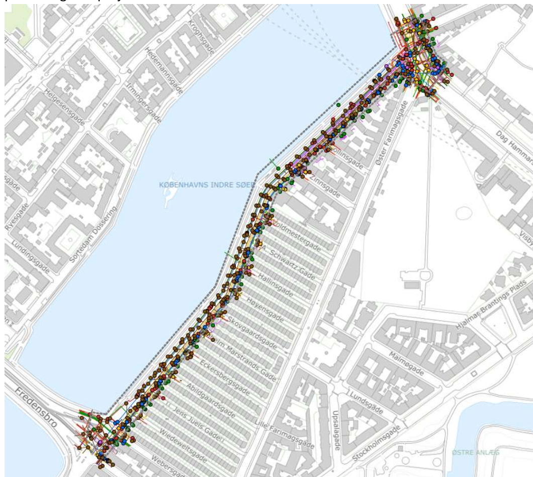
Figur 19: Illustration af alle eksisterende ledninger inden for projektområdet.
