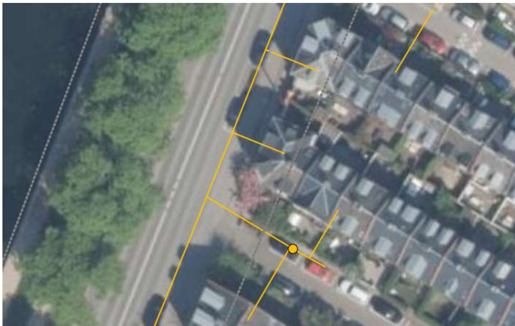
Figur 21: Eksempel på gasledningens placering langs Øster Søgade.
