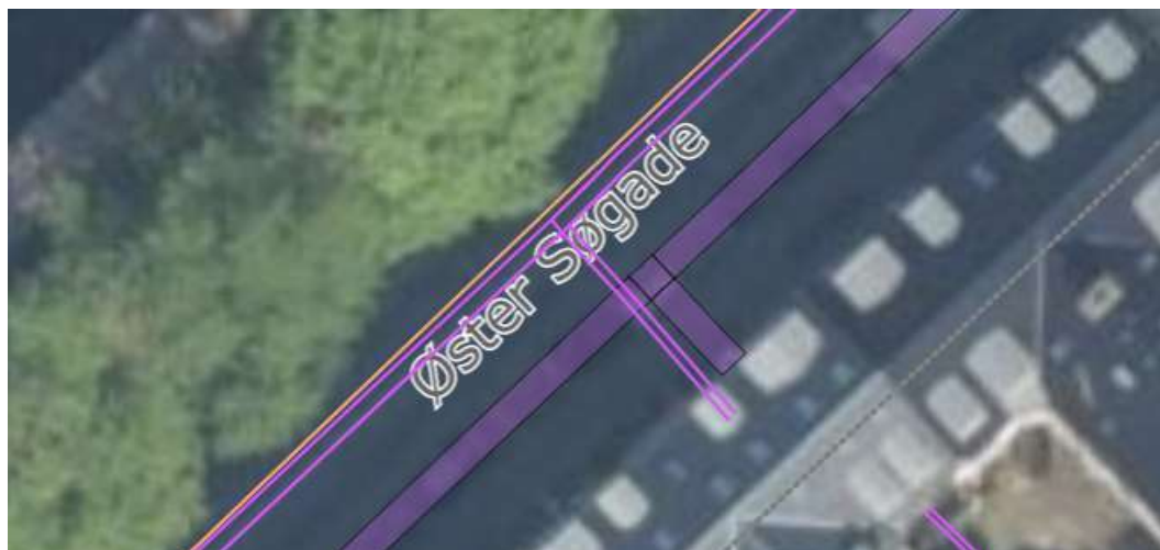
Figur 23: Eksempel på fjernvarmeledningernes placering langs Øster Søgade. Tyk lilla ledning er den 'døde' fjernvarmeledning. Smal lilla og orange ledning er ny gasledning.
