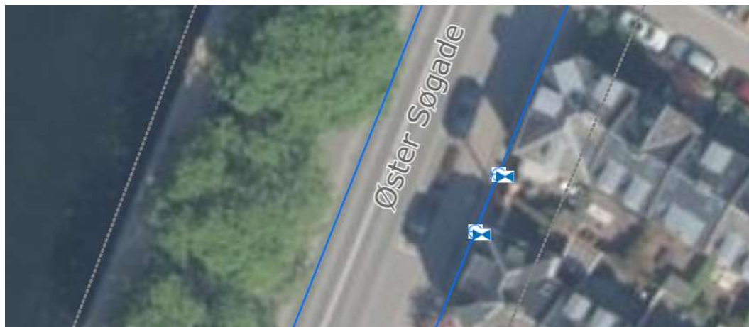
Figur 27: Eksempel på vandledningens placering i begge sider langs Øster Søgade.
